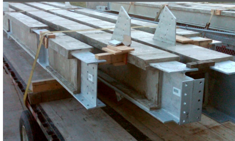
PYROCRETE APLICADO EN TALLER Y TRANSPORTADO AL SITIO DE TRABAJO.
