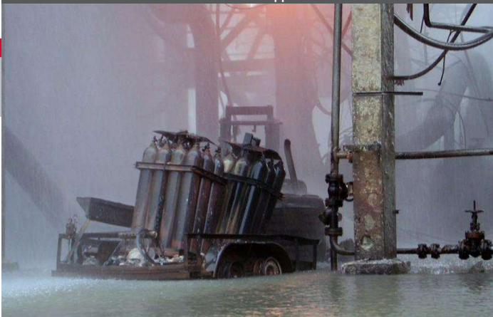
PYROCRETE ЖАБЫНЫМЕН ОРҒАЛҒАН ҚҰБЫР ЭСТАКАДАСЫ ТІРЕГІ КӨМІРСУТЕКТІ ӨРТКЕ ТӨТЕП БЕРЕДІ.
