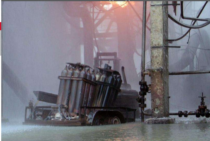
ОПОРА ТРУБНОЙ ЭСТАКАДЫ ЗАЩИЩЕНА PYROCRETE®241, ВЫДЕРЖИВАЕТ ВОЗГОРАНИЕ УГЛЕВОДОРОДОВ.
