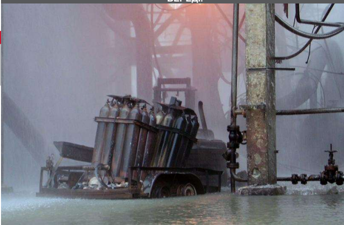
PYROCRETE ЖАБЫНЫМЕН ҚАПТАЛҒАН ҚҰБЫР ЭСТАКАДАСЫНЫҢ ТІРЕГІ КӨМІРСҮТЕКТІ ӨРТКЕ ТӨТЕП БЕРЕДІ.
