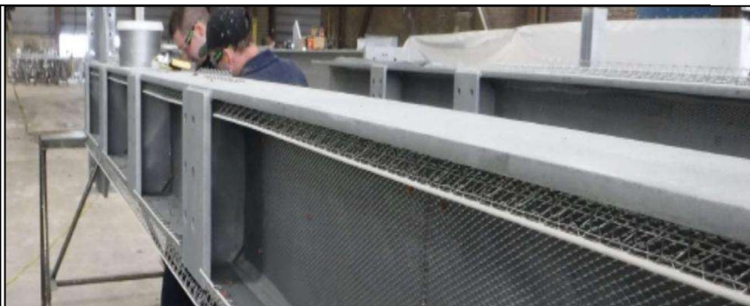
Бұрыштық профиль қалыңдықты бақылауға арналған түрде орнатылды
