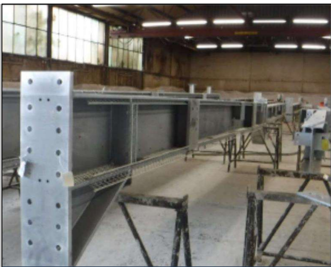
Латка және бұрыштық профиль қосылған таза мырышталған болат
